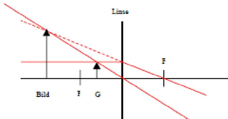
Die Grafik zeigt den Strahlenverlauf eines Mittelpunktstrahls und eines Parallelstrahls, wenn sich der Gegenstand innerhalb der Brennweite  $f$  befindet. Befindet sich der Gegenstand genau in der Brennweite der Linse (in diesem Fall des mit Wasser gefüllten Glases) so ist kein Bild sichtbar, da die Strahlen von der Linse als parallele Strahlen gebrochen werden.
