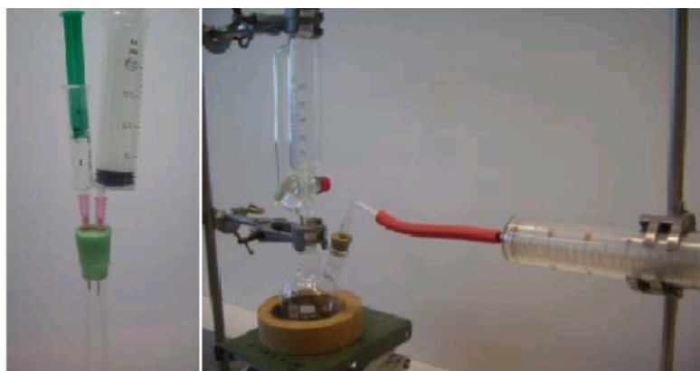
Figura 3.6. Dispozitive cu cost redus pentru experimente cu gaze și echipamente tradiționale de laborator
