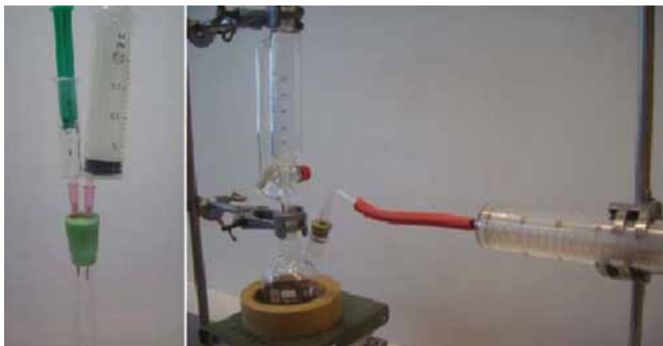
სურ. 3.6. გაზის მისაღები იაფი ხელსაწყო და ჩვეულებრივი ლაბორატორიული აღჭურვილობა
