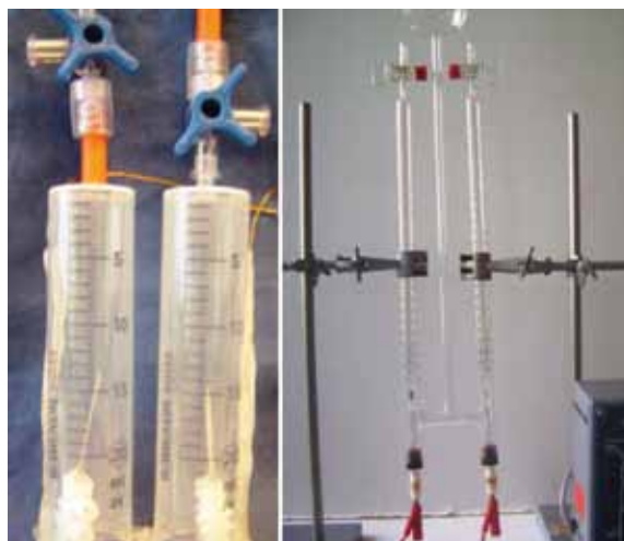
სურ. 3.5. სამედიცინო წარმოების ელემენტებისგან და ქარხნულად დამზადებული ჰოფმანის ხელსაწყო შედარება
