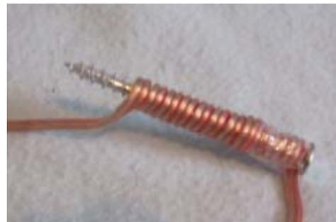
*Abb. 7.5: Mit Klingeldraht umwickelte Schraube*
