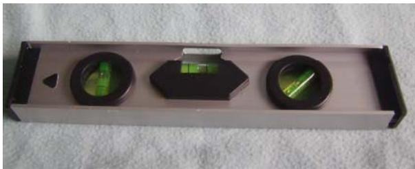
*Abb. 9.1: Wasserwaage*
