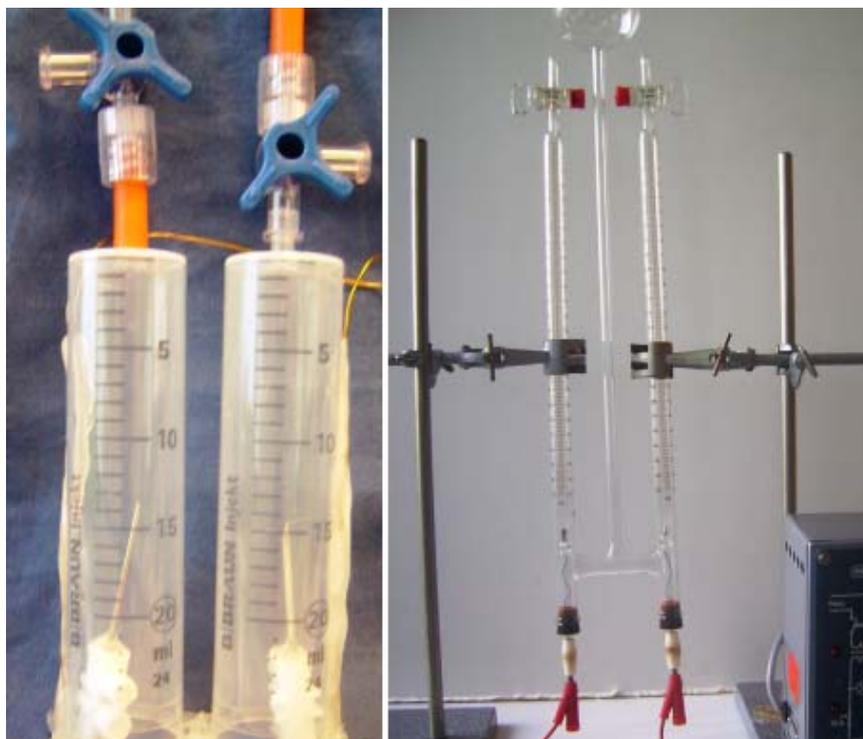
*Abb. 3.5: Gegenüberstellung eines Hoffmann-Apparats aus Medizintechnikteilen und als Glasgerät*
