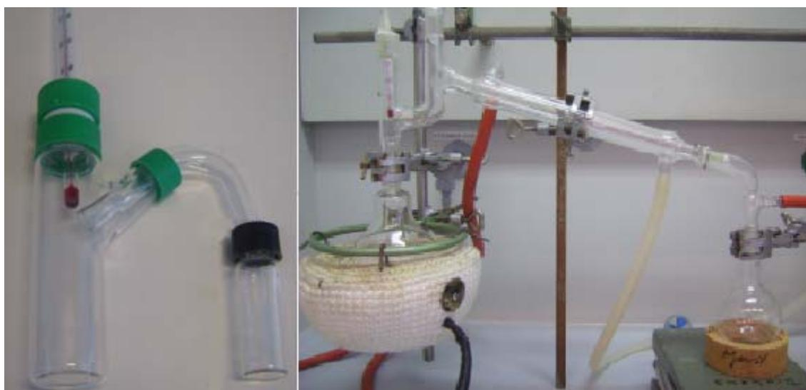
Abb. 2.1: Destillationsapparatur aus dem Minilabor und mit klassischen Laborgeräten
