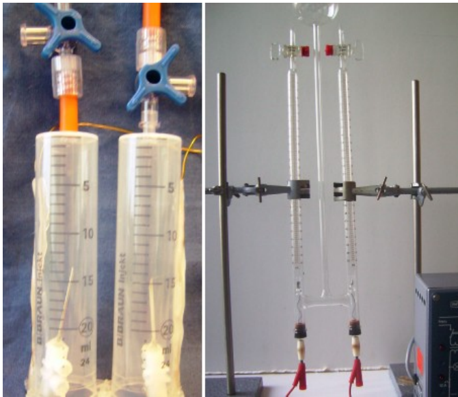
Фигура 3.5: Сравнение на уред Хофман с изработени от медицинско инженерство елементи и съответните произведени от стъкло.
