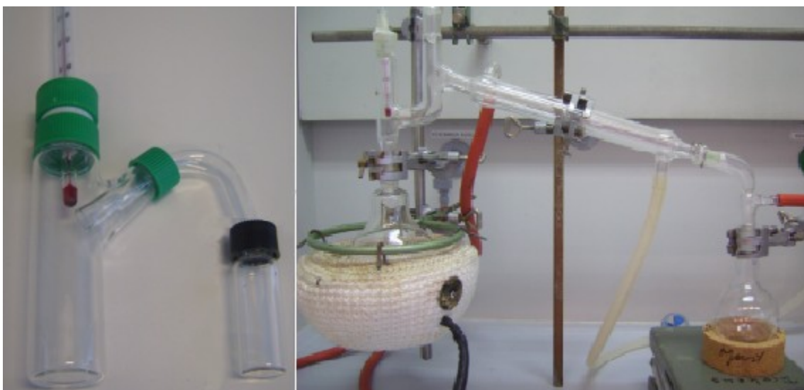
Фигура 2.1: Инструмент за дестилация в мини лаборатория и традиционното оборудване за лабораторията
