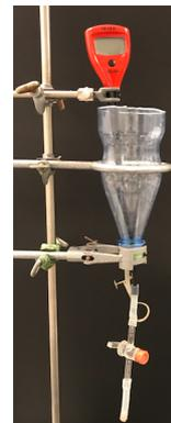
Zunächst muss die Wasserflasche ungefähr halbiert werden. Hierfür kann ein Messer erhitzt werden (Bunsenbrenner oder Feuerzeug) und damit die Flasche durchgeschnitten werden. Wir nutzen eine 1L Flasche gängiger Marken.
