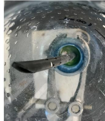
Auf den perforierten, festen Schlauch wird ein flexiblerer gesteckt, an dem der 2-Wege-Hahn befestigt wird. Am Ende des 2-Wege-Hahns wird wieder ein flexibler Schlauch befestigt. In diesen wird eine Kanüle mit abgebrochener Nadel geführt. So können die Spritzen später optimal aufgesteckt werden. Um den Auslass zu verschließen, nutzen wir eine Schlauchklemme.
